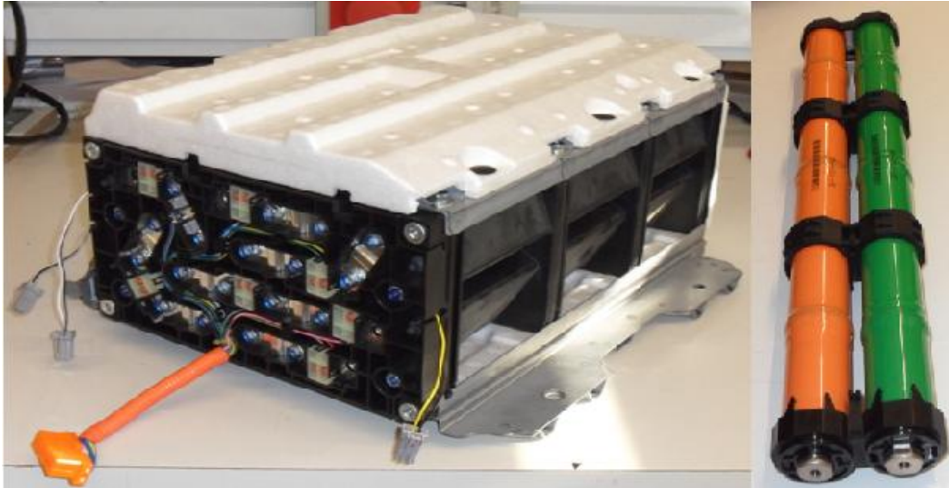
Figura 3.1 - Pack de baterias Ni-MH, com invólucro, ligações e terminais para sensorização, à esquerda. Na direita um módulo composto por 12 células.
