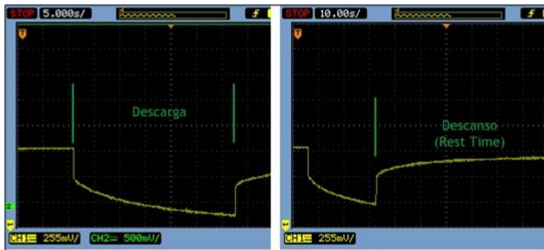
Figura 3.3 - Resposta da tensão da bateria a uma carga: dinâmicas de descarga e rest time.
