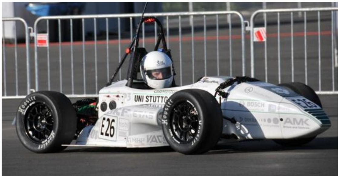
O sistema de propulsão é constituído por controlador ETAS ES910, 2 motores AMK DT5-26-10-POW com potência máxima de 56 kW/motor e binário máximo de 1140Nm (soma nas rodas), apresentando um binário máximo de 1140 Nm (somatório das rodas). O motor é localizado na traseira do veículo e a massa de cada motor é de 8 Kg, apresentando eficiências na ordem dos 95%. O controlo é feito através de Torque-Vectoring e *slip regulation*. O carro permite uma aceleração de apróx. 3,0s dos 0-100 km/h.
