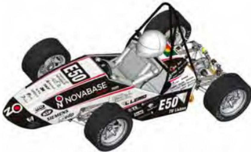
O veículo tem dois motores elétricos DC de ímanes permanentes Agnimotors 95-R AC com potência máxima de 30kW e com binário máximo de 60Nm por motor acoplados a uma caixa de transmissão 520 Chain e com diferencial Torsen FSAE 012000, 4:1 TBR alimentado por células de lítio de fosfato de ferro, 48s5p.
